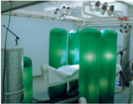
Abb. 1: GZO-Spital Wetzikon (Schweiz) Musterlastanordnung für die Qualifizierung eines OP-Saales.
